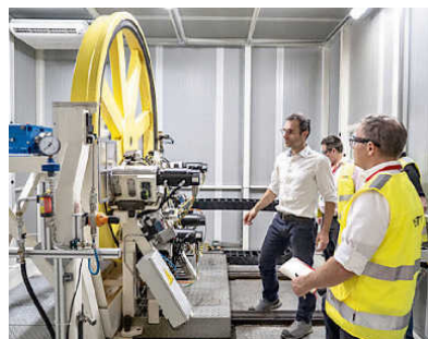
Operai al lavoro e il roller brevettato da Wabtec per testare le ruote
